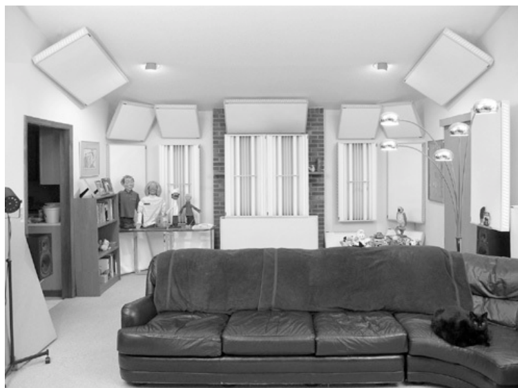
Hình 19.8: Phía sau phòng khách Ethan, có bốn bộ khuếch tán ở phần trung tâm tường, cộng với bảy bass ở những góc tường phía sau và bên hông. Bộ khuếch tán trung tâm nằm trên nhiều bass xử lý góc tường phía sau. Vải terry dày phủ lưng ghế da couch cũng để giảm phản dội.
