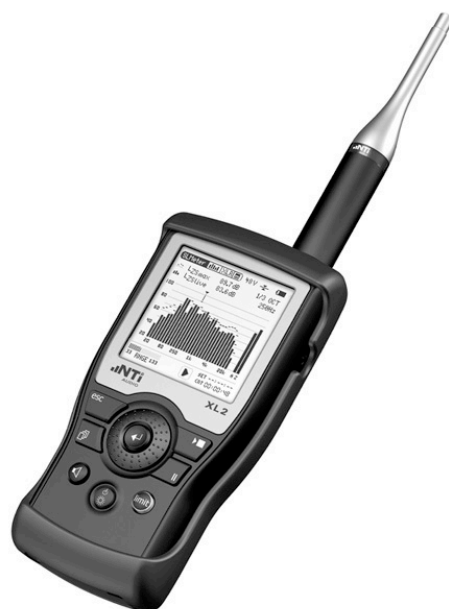
Hình 19.22: NTI Audio XL2 cung cấp một bộ phép đo toàn diện theo yêu cầu của nhà âm học chuyên nghiệp.
